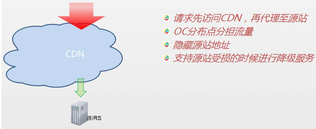
分布式 DDOS 安全防护，主要通过 GSLB 系统对流量进行迁移，引导到全国各地的节点上分而治之。在单个 CDN 节点部署的安全防护模块，能够有效对流量进行拦截和清洗，过滤出正常流量进行服务。同时，监控系统能够快速识别出单机节点是否承受较大攻击压力，依靠 OSPF、虚拟 IP 等技术，能够快速扩容，顶住攻击压力，为客户源站护航。
